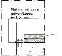
TIPUS SE63.3 TRENCAIGÜES BARANA ml: XXm
