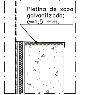
TIPUS SE63.8 TRENCAIGÜES MITGERA ml: XXm
